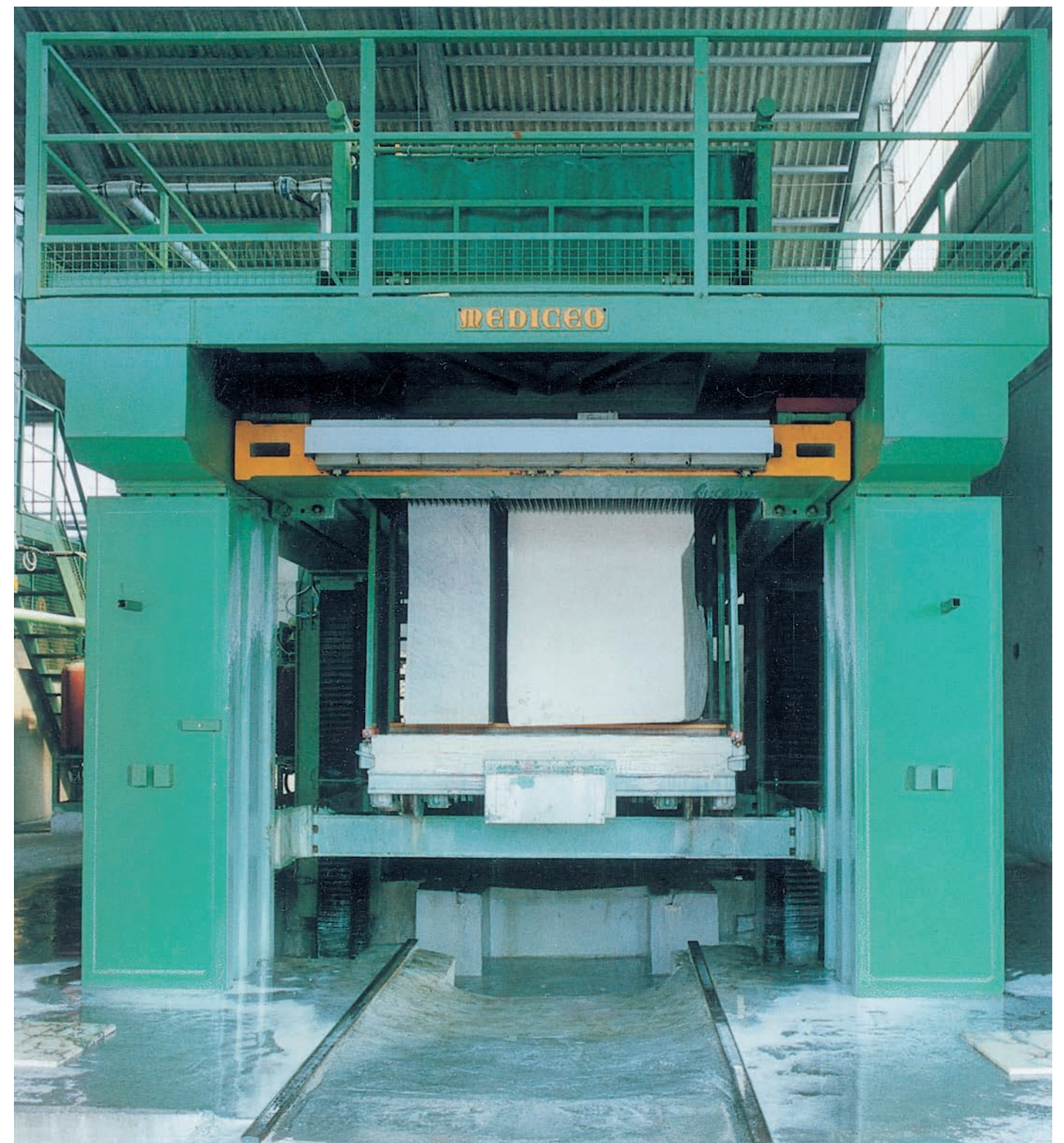
VISTA FRONTALE DEL TELAIO FAST DURANTE L'OPERAZIONE DI SEGAGIONE.
