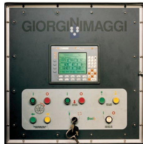
QUADRO ELETTRICO DEL TELAIO COMPLETO DI MONITOR
